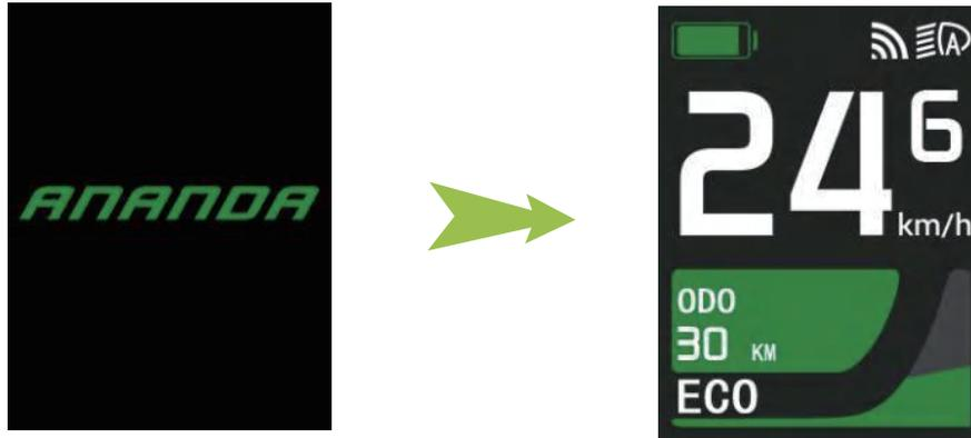
Drücken Sie lange auf die Taste "
