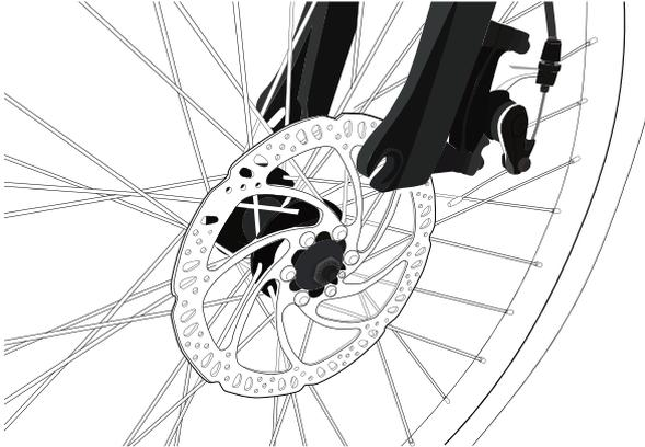
Rasten Sie die Gabel in die Feder des Schnellspannhebels am Reifen ein.und Scheibenbremse auf der linken Seite.
