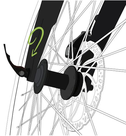
Drücken Sie nach dem Festziehen der Achse den Hebel, um sie zu sichern.
